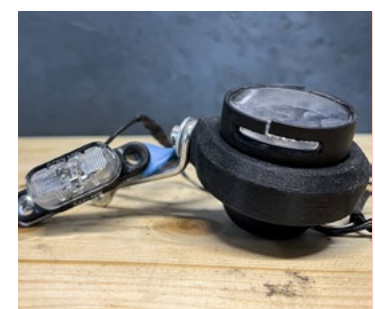
Die Lampe ist mittels 3-D-Druck selbst hergestellt.
