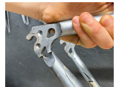
Der Rahmen ist auf Höhe der Hinterradachse gebrochen.
