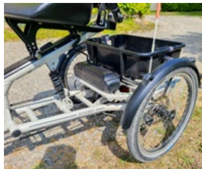
Gefederter Sessel, der sich per Schnellspanner problemlos verstellen lässt.
