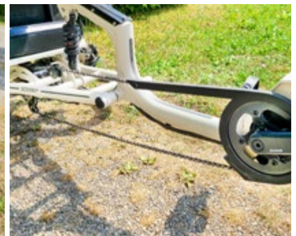
Die lange Kette verbindet die 14-Gang-Schaltung von Rohloff mit der Kurbel.
