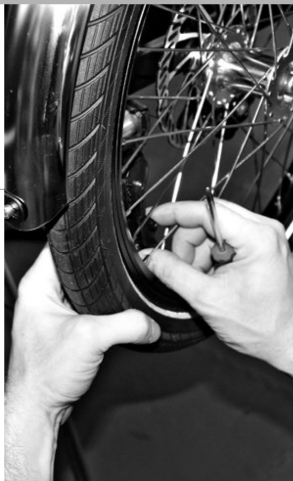
Der Fachmann bei der Arbeit, hier beim Montieren eines Nabenlichts.
